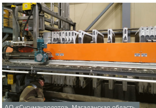
АО «Сусуманзолото», Магаданская область, фильтр-прессы площадью поверхности фильтрации 200 кв. м
